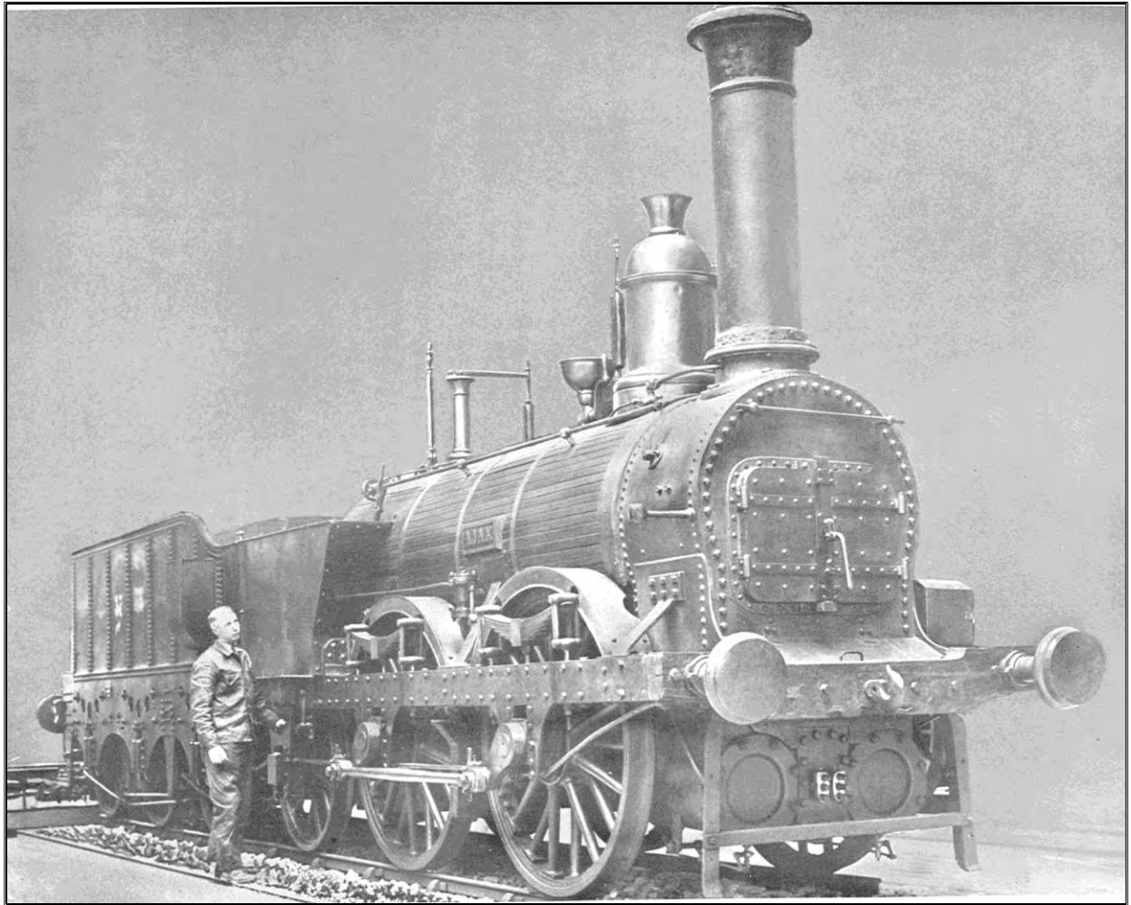
Die Dampflokomotive „Ajax“ mit einem Gewicht von 28,7 Tonnen wurde 1841 in Warrington (England) für die 1838 eröffnete „Kaiser-Ferdinands-Nordbahn“ gebaut.
