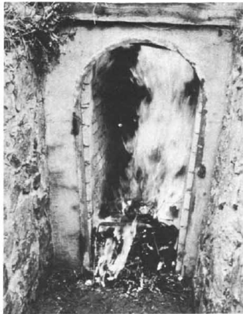
Das verhältnismäßig kleine Feuer wurde im Zugang des horizontalen Erdstalleingangs entfacht. Die Flamme loderte in den Gang hinein. Die beiden Männer der Grubenwehr berichteten, daß es ihnen zuerst einmal sehr, sehr warm wurde. Es bildete sich innen ein ausgiebiger Hitzestau. Durch Rauchschwaden verringerte sich die Sicht auf kaum mehr als 30 cm. In einem solchen Brandfall gibt es im Erdstall keine Überlebenschmöglichkeit. Foto: Schwarzfischer
