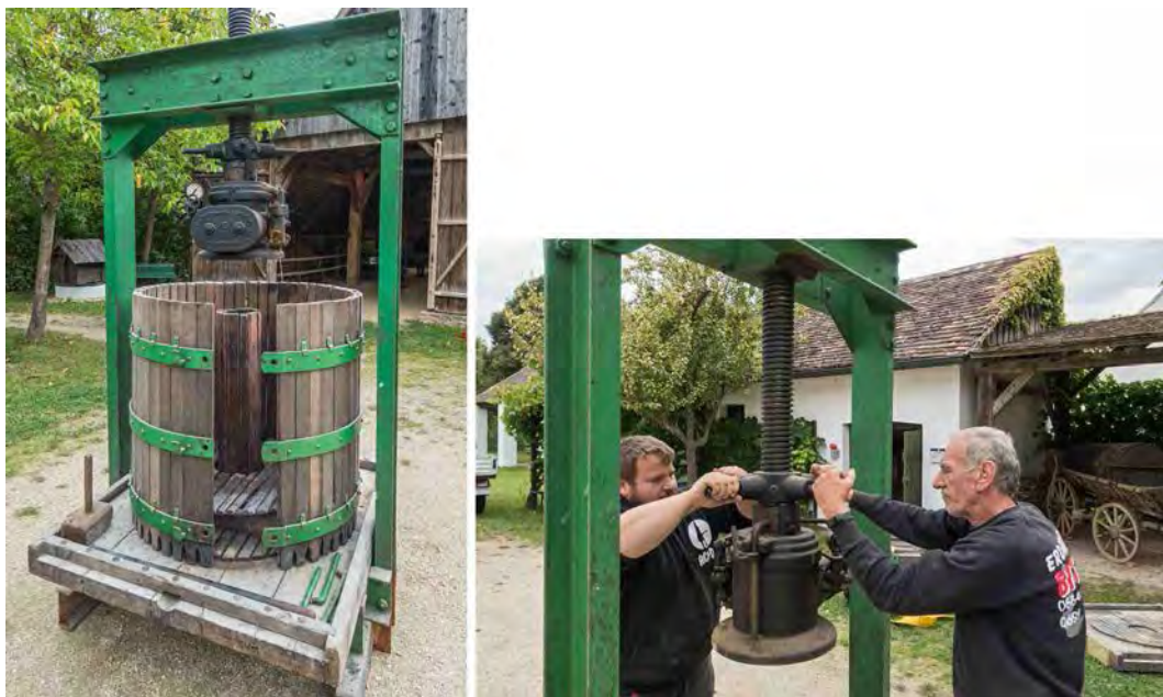
Obr. 11 Rámový vinný lis a zaměstnanci „Transporte-Seymann“ při instalaci tiskové jednotky, 2021.
