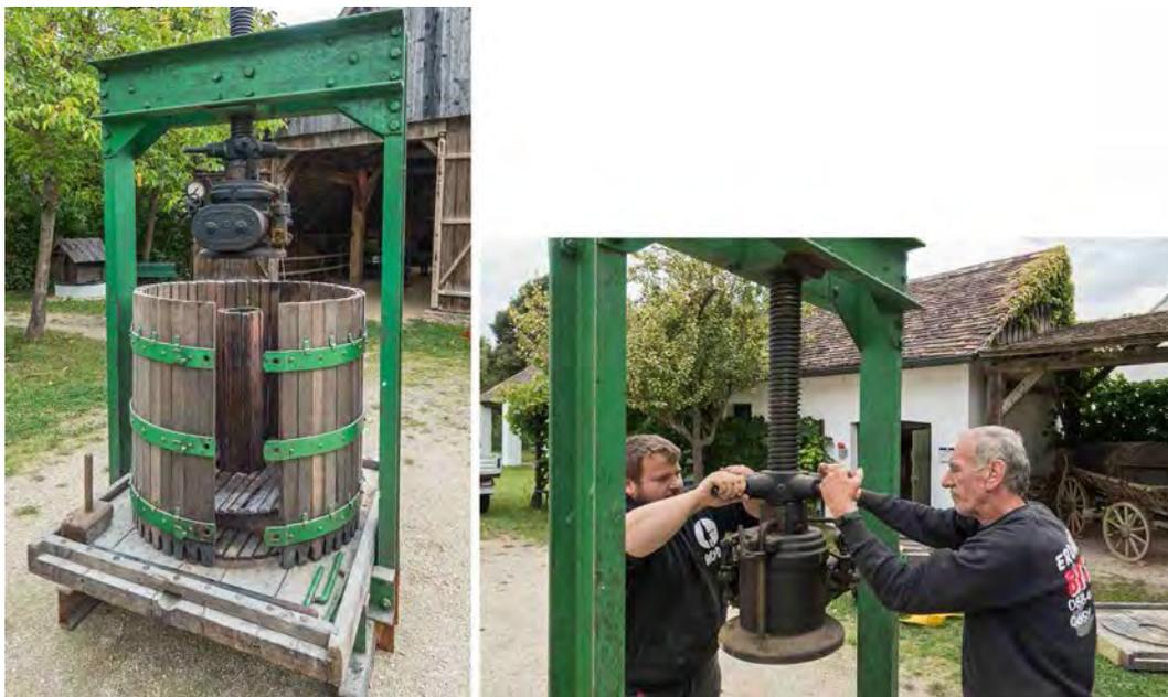
Abb. 11 Rahmen-Weinpresse und Mitarbeiter von „Transporte-Seymann“ beim Einbau des Druckwerks, 2021.
